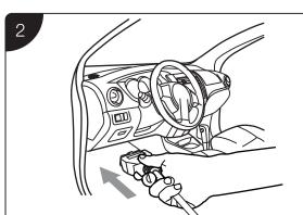
メインケーブルの16ピンオスアダプターを 車両のDLCに接続します。 DLCは通常、車両のダッシュボードの下にあります。
