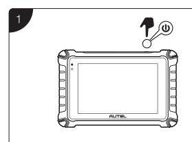
タブレットのバッテリーが十分に充電されているか、電源に接続されていることを確認してください。タブレットの電源を入れます。 (電源ボタン長押し)
