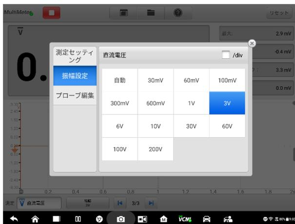
図 7-18 振幅設定画面のサンプル (DC 2.0V / div))
