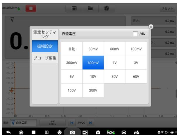
図 7-17 振幅設定画面 (DC 10V)
