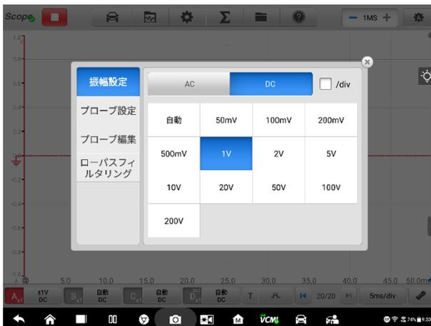
図 7-51 振幅設定画面 (DC 1.0V / div) のサンプル
