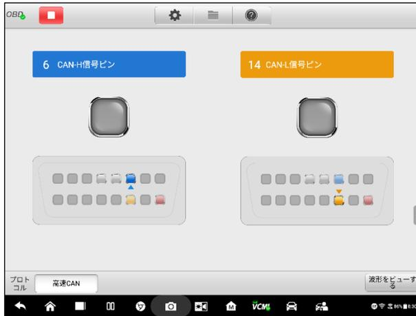
図 7-10 インジケータモード画面のサンプル
