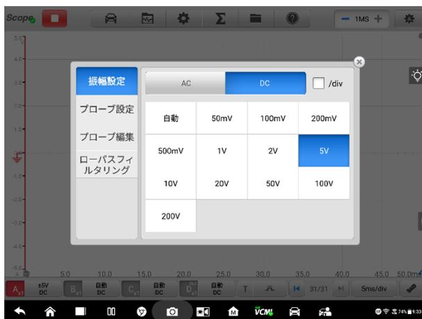
図 7-49 振幅設定画面 (DC 5V) のサンプル
