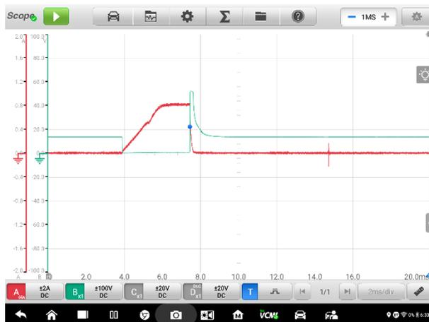
図 7-10 基準信号の波形表示のサンプル
