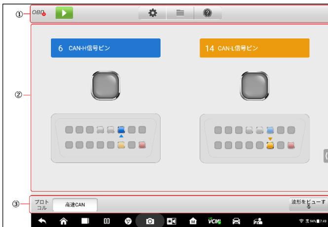
図 7-4 OBDII/CAN バスチェックメニュー画面のサンプル
