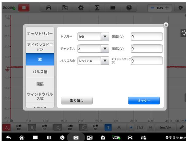
図 7-70 ウィンドウ設定画面のサンプル
