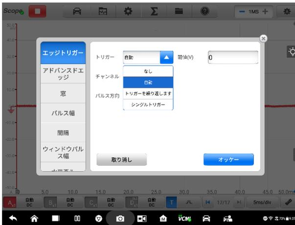
図 7-66 トリガーモード画面のサンプル
