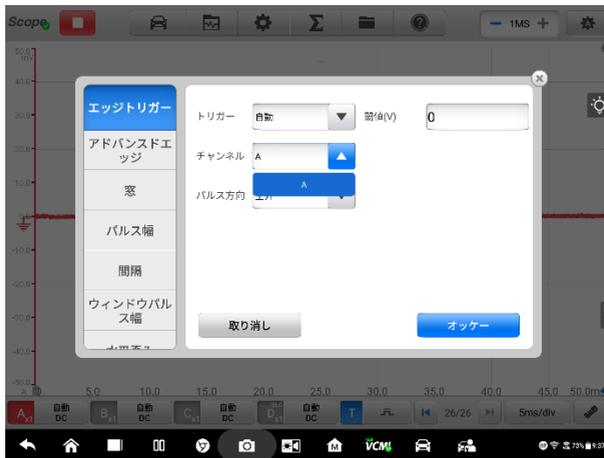
図 7-67 トリガーチャンネル画面のサンプル
